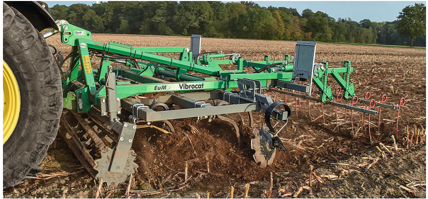
△ Die Frontwalze führt den Grubber ordentlich in der Tiefe. So lässt sich der Vibrocat auch ohne Nachläufer einsetzen. Zudem zertrümmert die Walze teilweise auch Maisstoppel.
