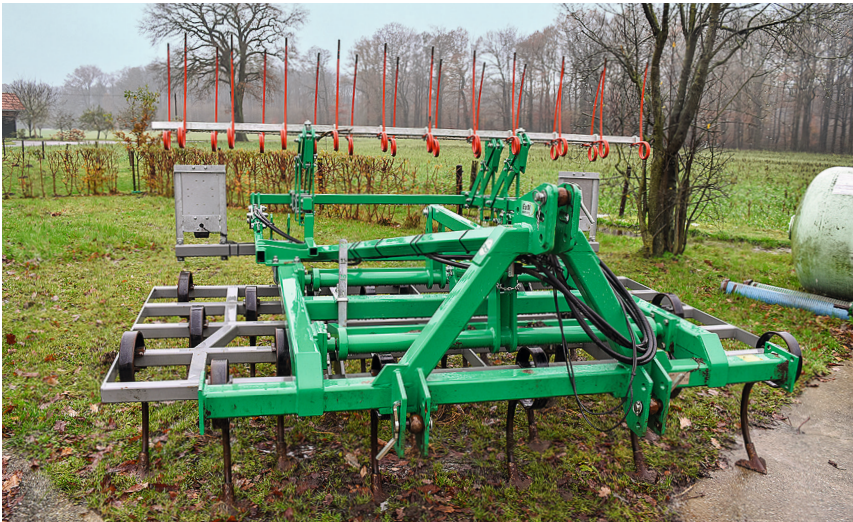
△ Oben: Hinten nehmen Haken das Gerät auf. Vorne müssen die Bohrungen genau übereinanderliegen. Unten: Eine ordentlich lesbare Skala zeigt die aktuelle Arbeitstiefe an.
