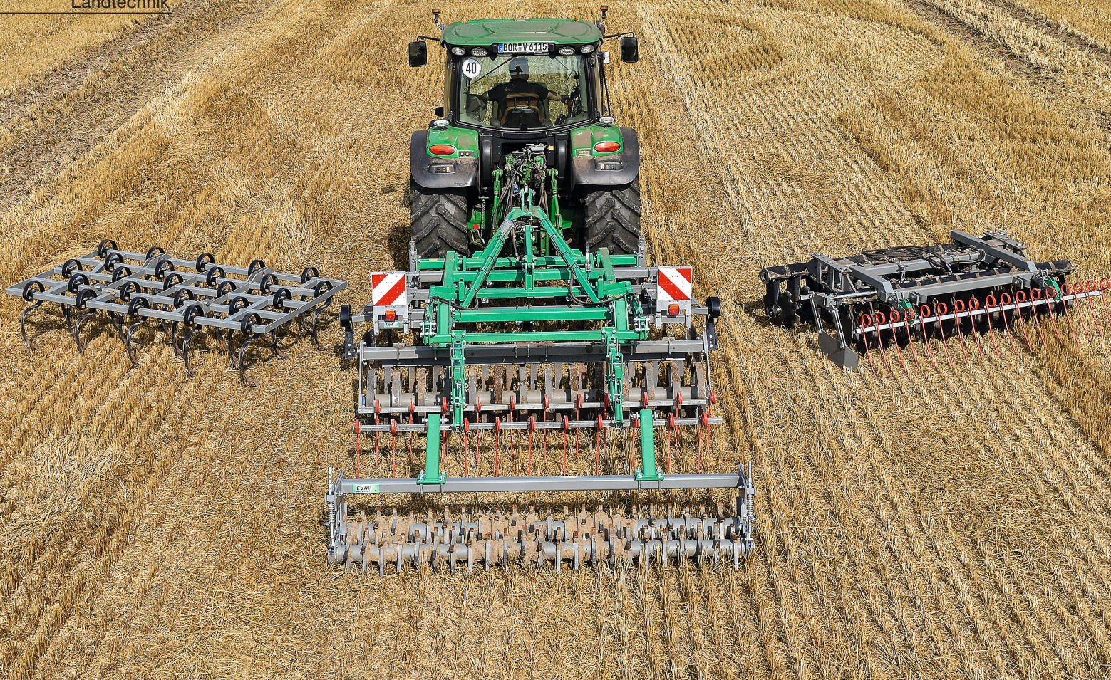
△ Per Schnellwechsellvorrichtung lassen sich die Arbeitsfelder und die Walze recht zügig tauschen.
