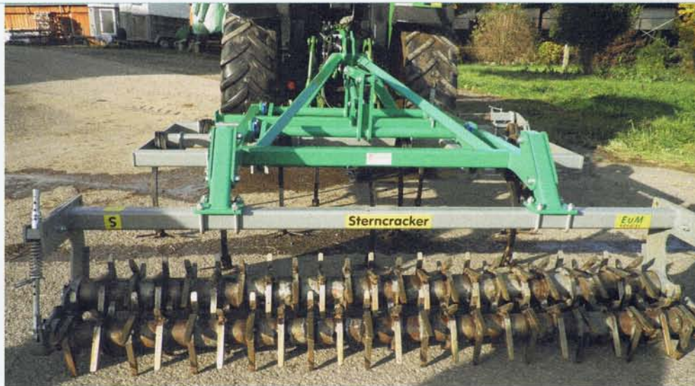
Vibrocat mit Zinkenfeld und Sterncrackerwalze als Nachläufer Fotos: H. Beutel
