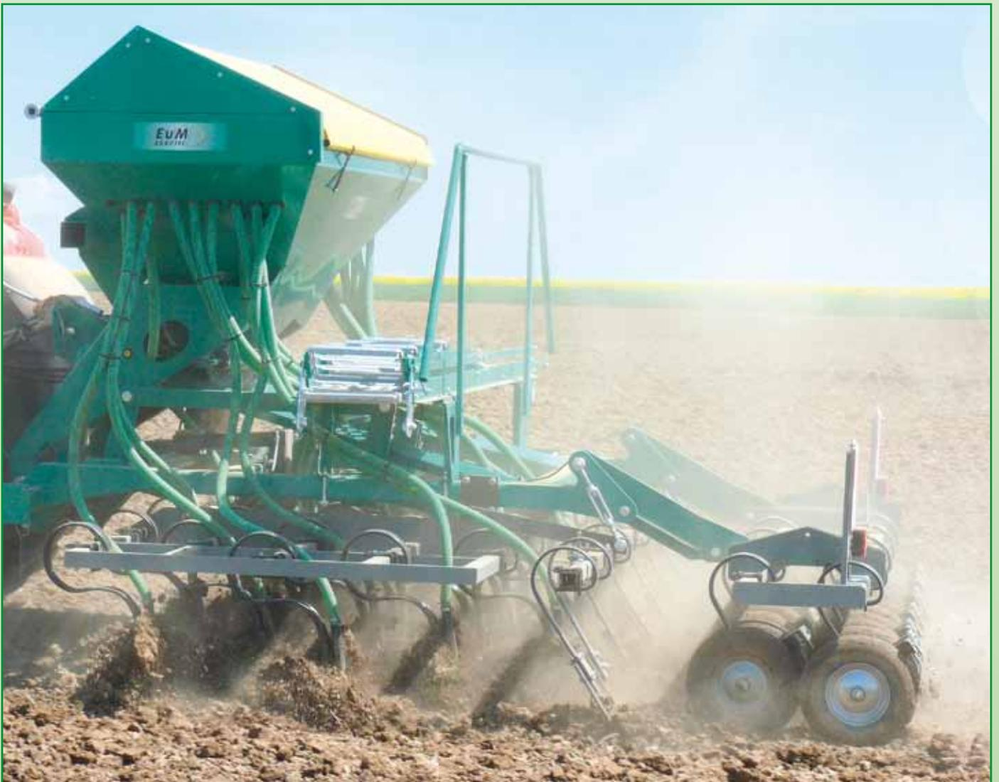
Pneumatische Zinkensämaschine für
