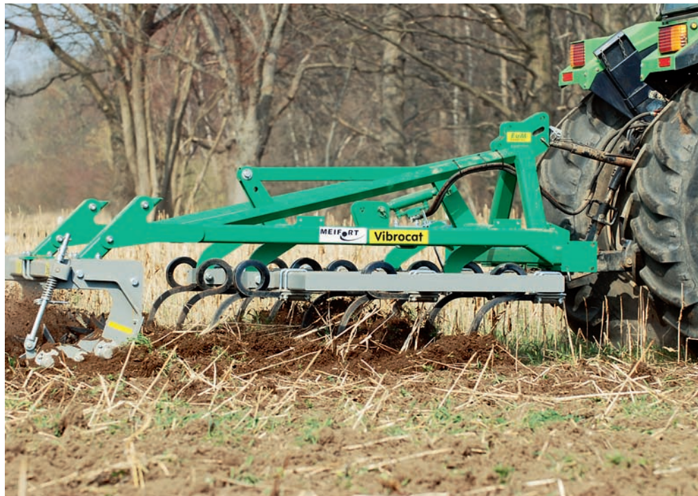
Interessante Tiefenverstellung mit Parallelogrammaufhängung und Hydraulikzylinder.
