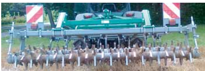
EuM-Grubber mit Beleuchtung und Warntafeln.
