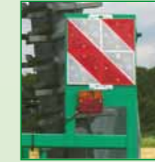
Beleuchtung mit Warntafeln
