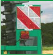
Beleuchtung mit Warntafeln
