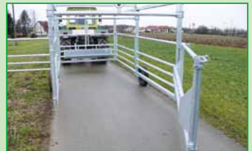
Abstandsschutz an der hinteren Tür vermeidet Verletzungen der Tiere
