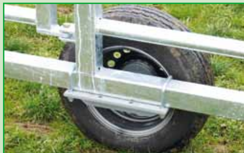
Leicht demontierbare Transporträder 175x14 zur Nutzung als Unterstand bei Ausrüstung mit Dach
